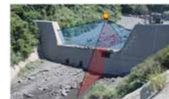
【測域センサーのイメージ】 レーザー測距により走査線上の表面形状を取得するセンサー
