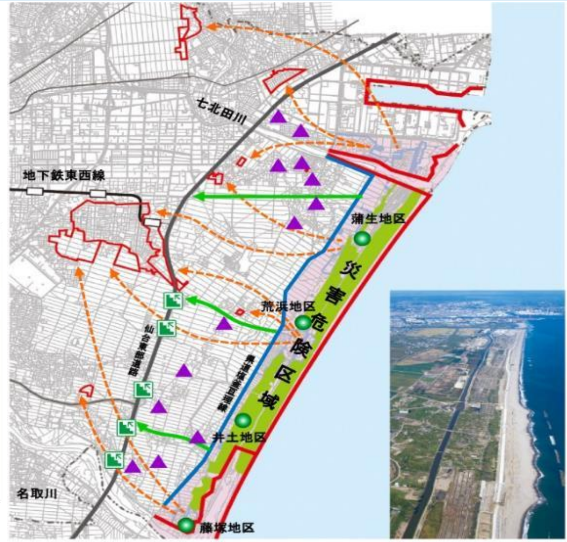
平成27年9月撮影 海岸堤防・河川堤防など かさ上げ道路 避難の丘 海岸防災林 災害危険区域(内陸への移転) 内陸の移転先 避難道路 防災集団移転の動き 避難施設 東部道路避難階段
