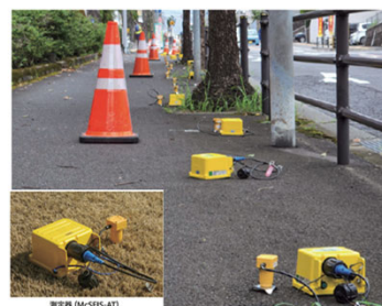
現地ではケーブルレスの測定器を並べて振動を観測します
