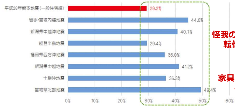
図 2-1 近年の地震における家具類の転倒・落下・移動が原因のケガ人の割合
