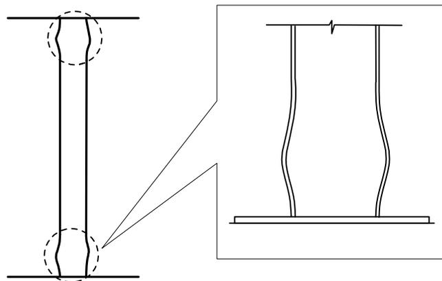
(図2) 鉄骨造：梁の局部座屈
