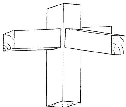
(図2) 柱の折損
