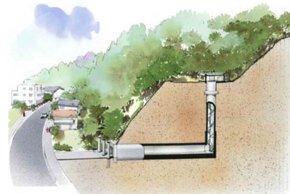
〔津波避難シェルター〕
