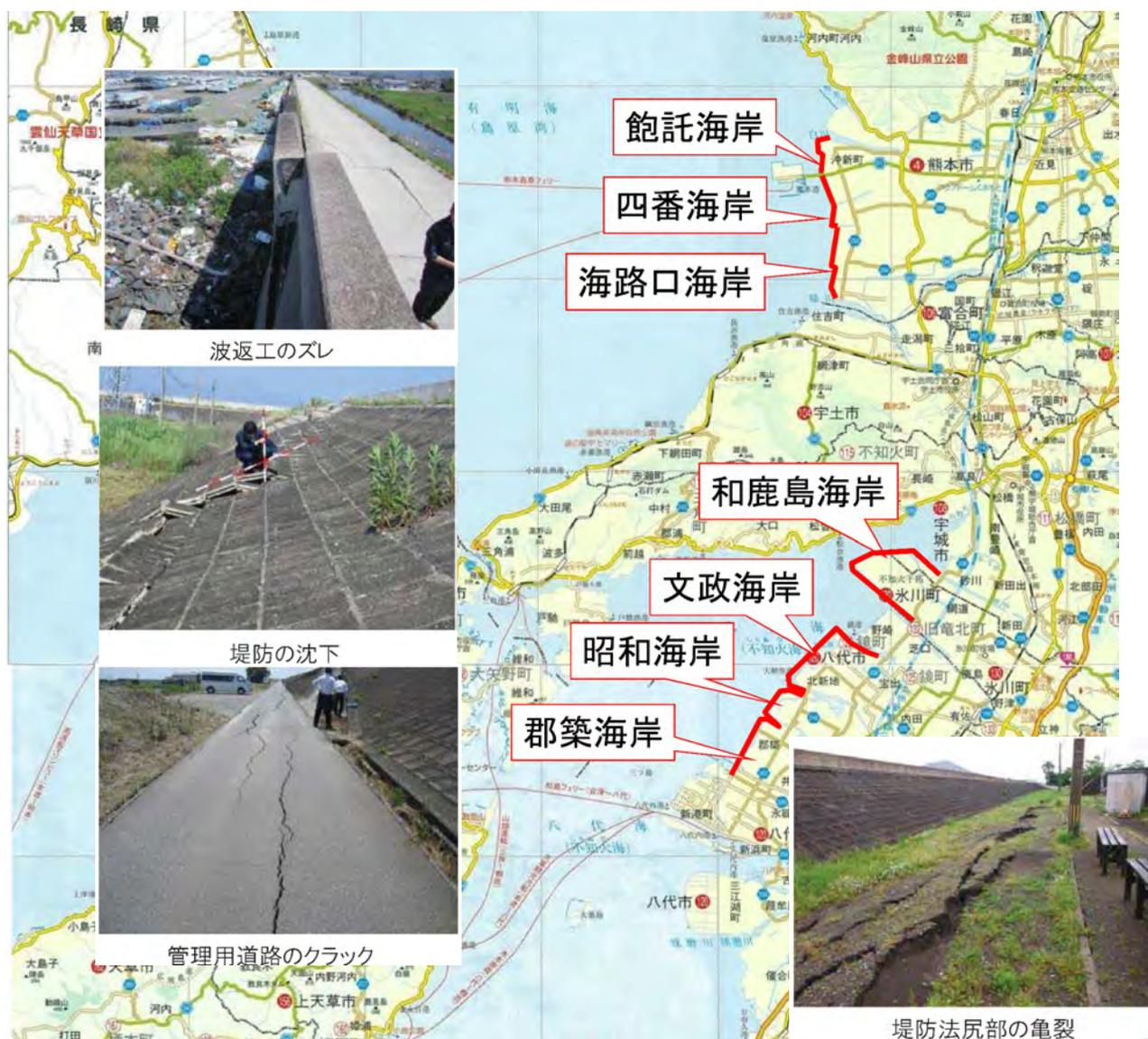
図 農地海岸災害復旧事業の直轄代行位置図と被災概況
