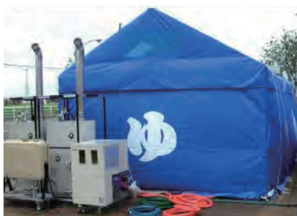
仮設入浴設備
