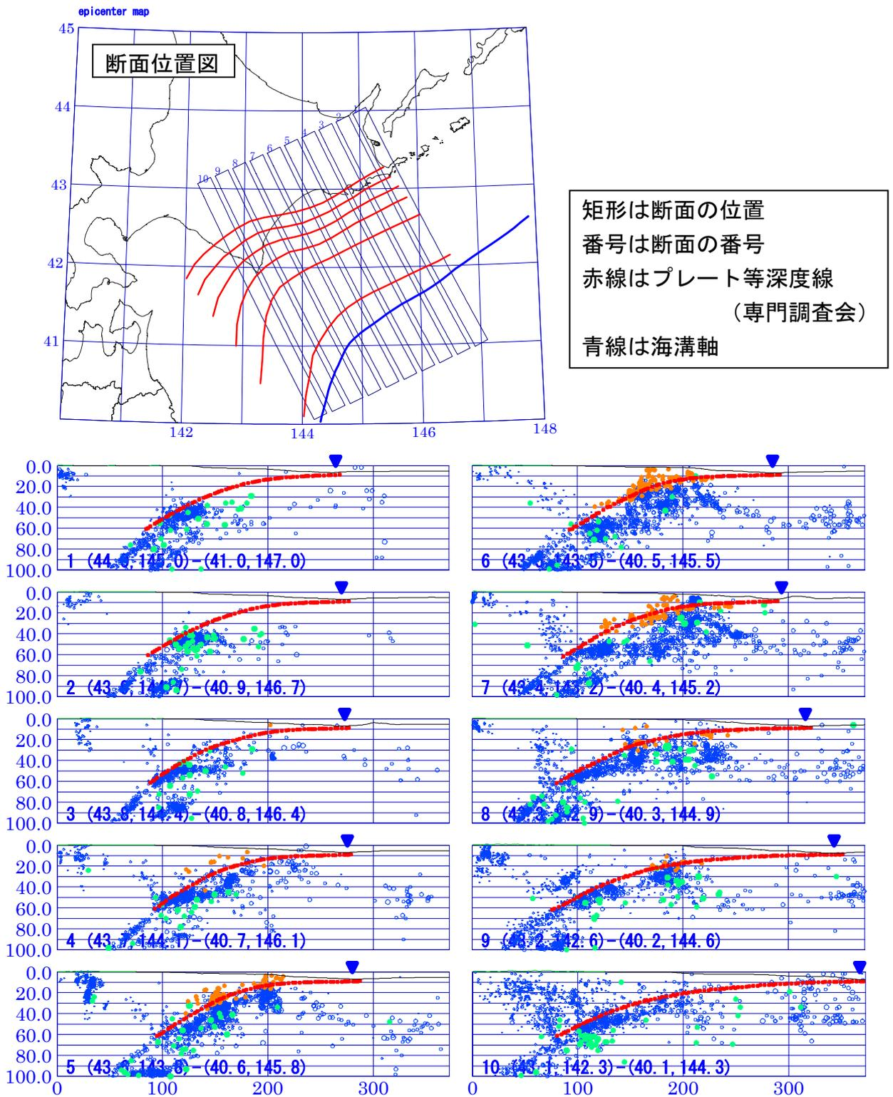
図5-1. プレート形状の断面図
