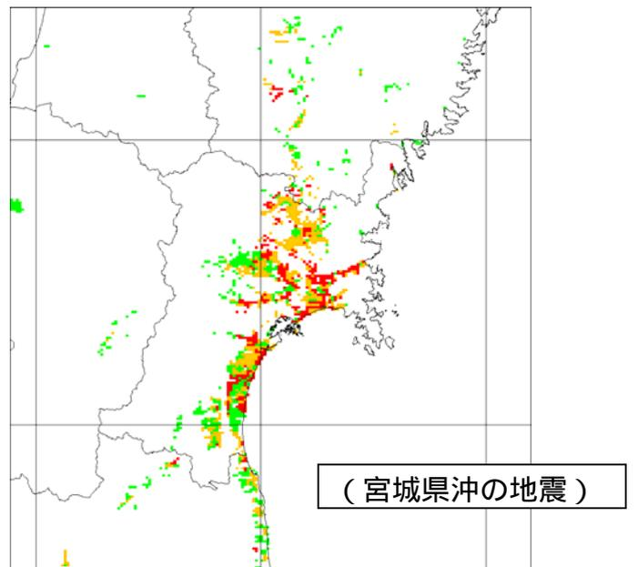
図 2 各地震の液状化可能性の分布想定図(PL法)
