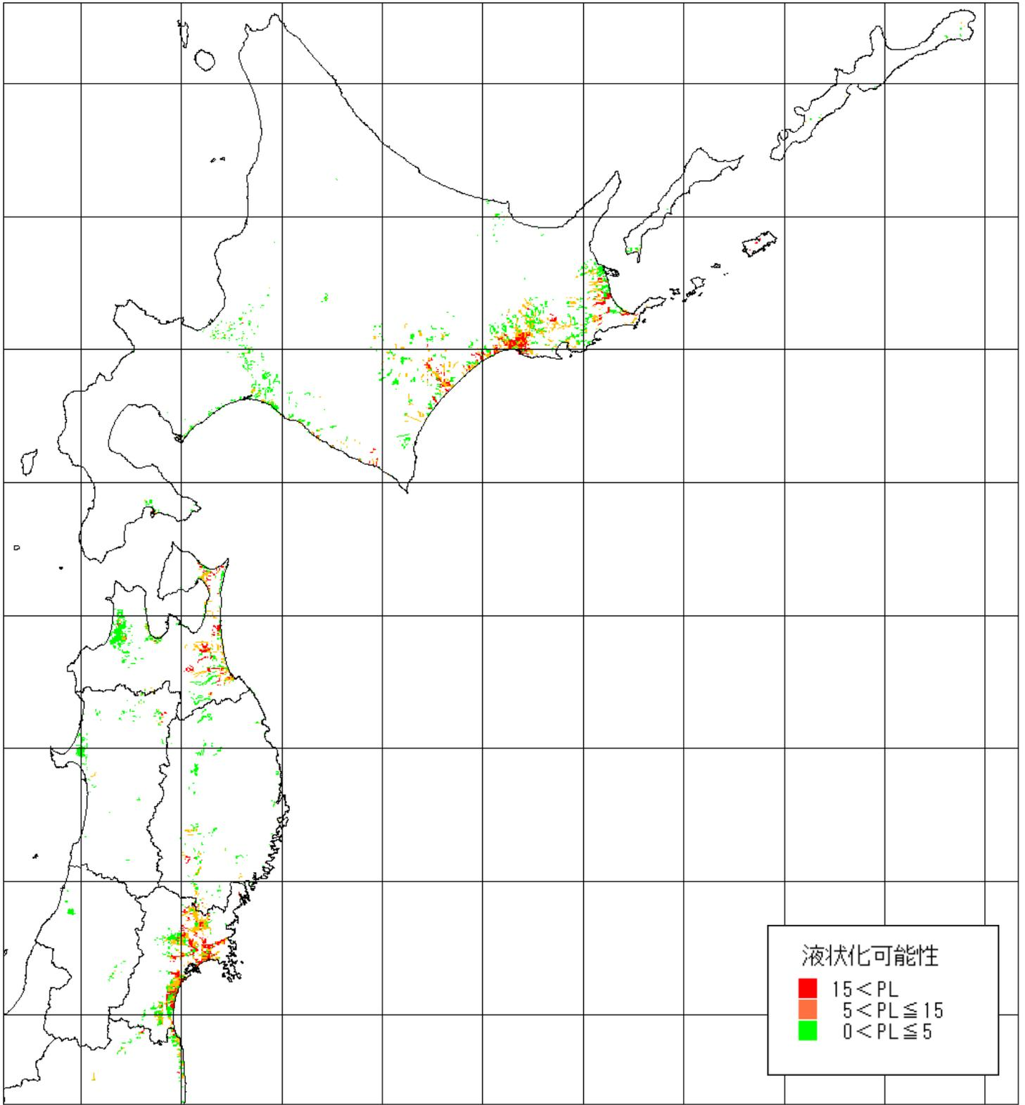
図 1 液状化可能性 (PL 法) (各地震の重ね合わせ)
