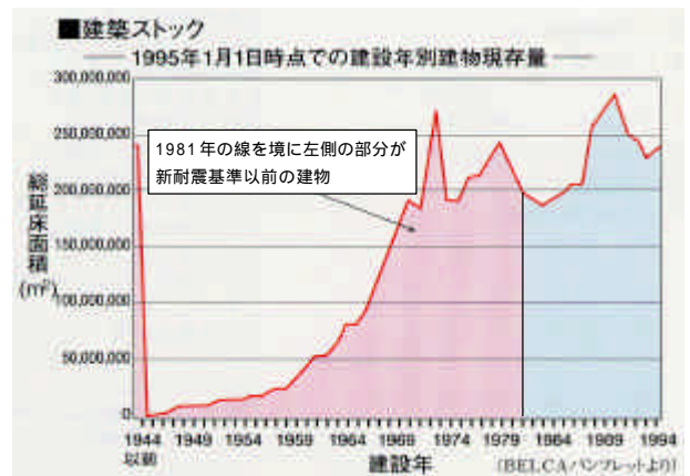
図-3 わが国の建築構造物のストック (昭和56年以前に建築された建築物のうち, 耐震診断が必要と推定される建築物は, 住宅が1200万棟, 非住宅は220万棟と言われている.)
