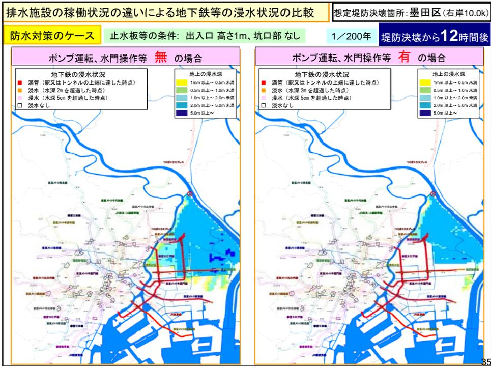
排水施設の稼働状況の違いによる地下鉄等の浸水状況の比較 想定堤防決壊箇所: 墨田区(右岸10.0k)
