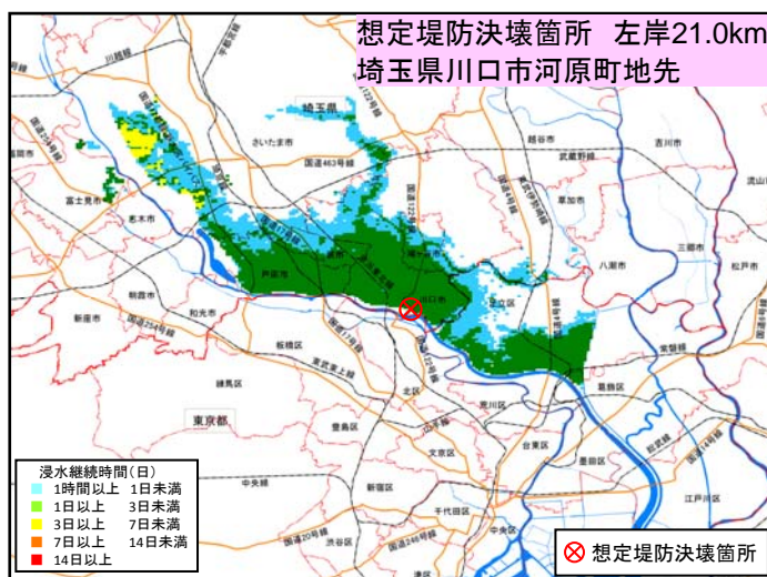
②-1 荒川左岸低地氾濫(中川・綾瀬川満杯)
