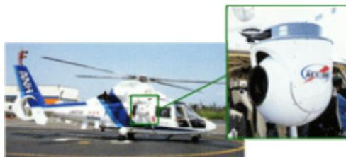
(ヘリの窓側に設置された白いボールのような装置にカメラが組み込まれている)
