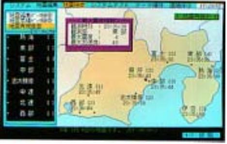
SIPOS (サイボス):各種気象情報や国土交通省のレーダー情報、県設置の雨量計や河川の水位計のテレメーター情報を収集。
