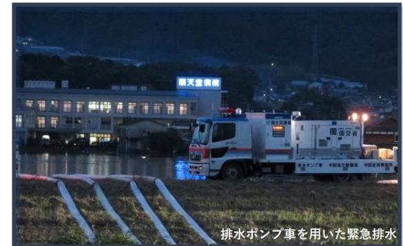
排水ポンプ車を用いた緊急排水
