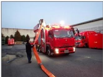
約2,000mのホース延長が可能。ポンプ装置は、最大毎分8,000ℓ、落差50mからの揚水が可能。車両が水源に接近できない場合でも、水平距離60mまで水中ポンプを移動させ揚水することが可能。
