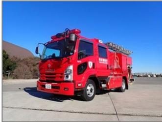
最大で毎分2,000ℓ以上放水可能なポンプを搭載した車両。資器材収納ボックスを設けた車体形状（セミボックス型）とし、動力ホースカー及び手引きホースカー、三連はしご、単はしご等を装備。
