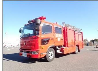
危険物製造工場やタンクローリー横転等の危険物火災及び普通火災時での消防活動を目的とした車両。容量1,500ℓの水槽、容量300リットルの泡剤槽及び泡混合装置、泡放射銃、各種最新の発泡器具を装備。
