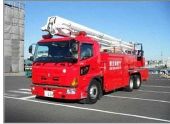
最大地上高22mの二節ブーム式屈折放水塔を装備した車両。高所火災、危険物火災など消防隊が容易に近づけない火災現場において、高所から効果的に注水及び泡放射を行う。
