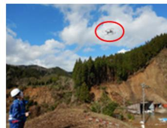
▲ドローンによる土砂災害調査
