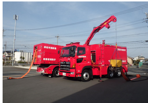
海水利用型消防水利システム
