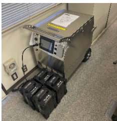
燃料油を使用しない電源の例（バッテリー）
