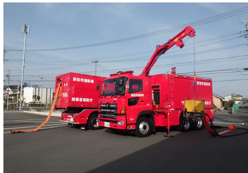
海水利用型消防水利システム
