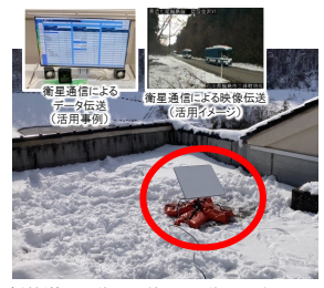
低軌道周回衛星を使用した衛星通信装置(今回の対応で活躍したものの、数が限られていた)
