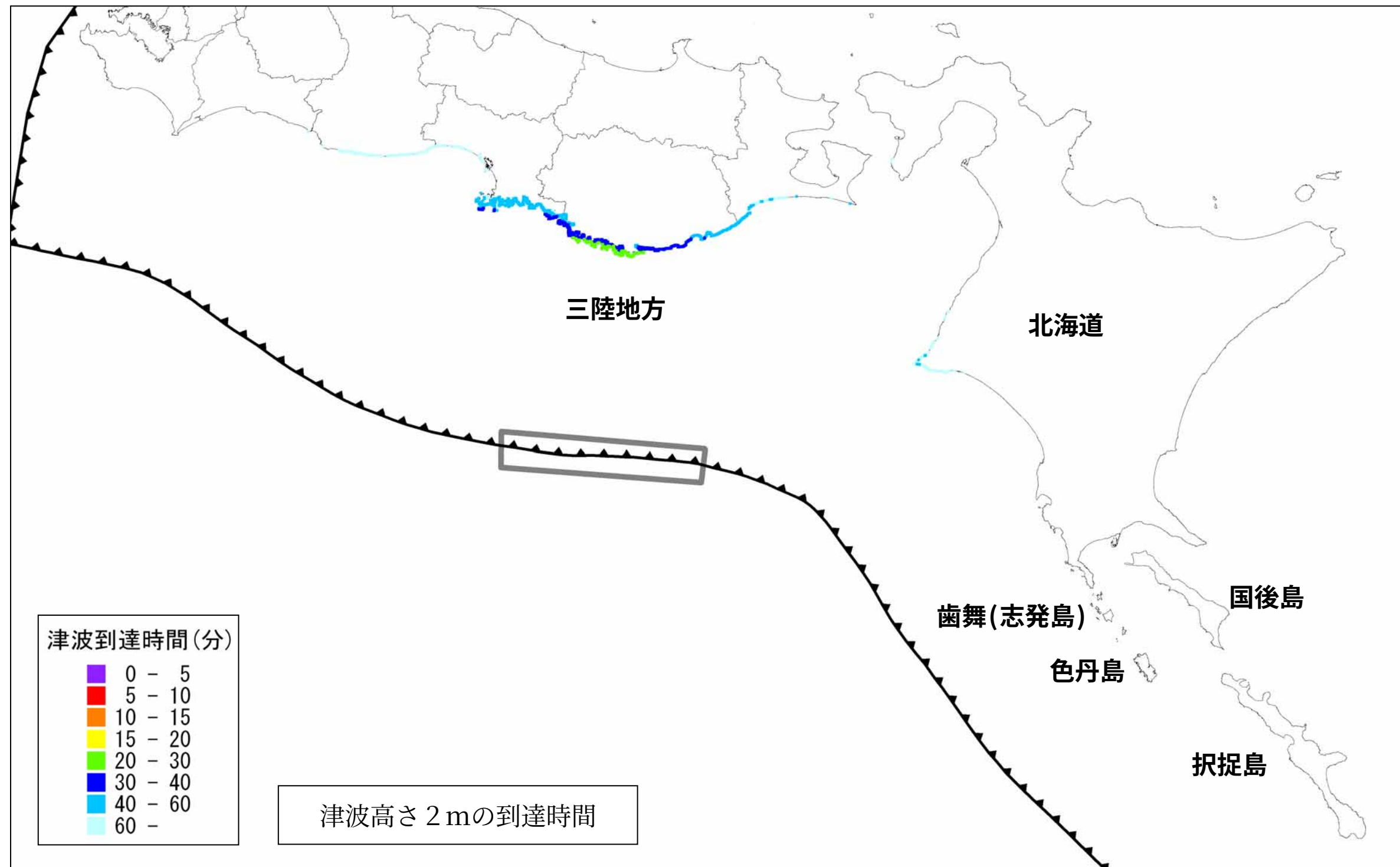
図 3-3-13-4 津波到達時間(津波高さ 2 m、平均潮位) : 1933 年昭和三陸地震
