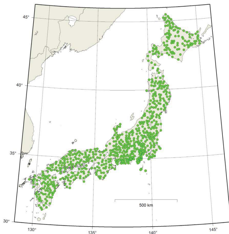
図 2-3 防災科学技術研究所 高感度地震観測網(Hi-net) 高感度加速度計設置観測点分布図
