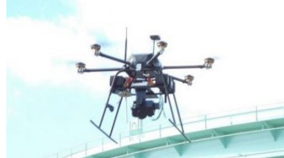
ドローンによる高所点検
