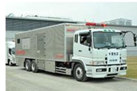
大型移動電源車（通信ビル用）
