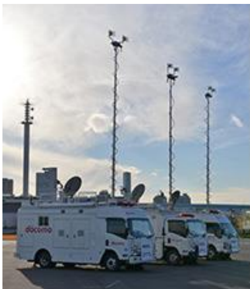
衛星エントランス搭載 移動基地局車
