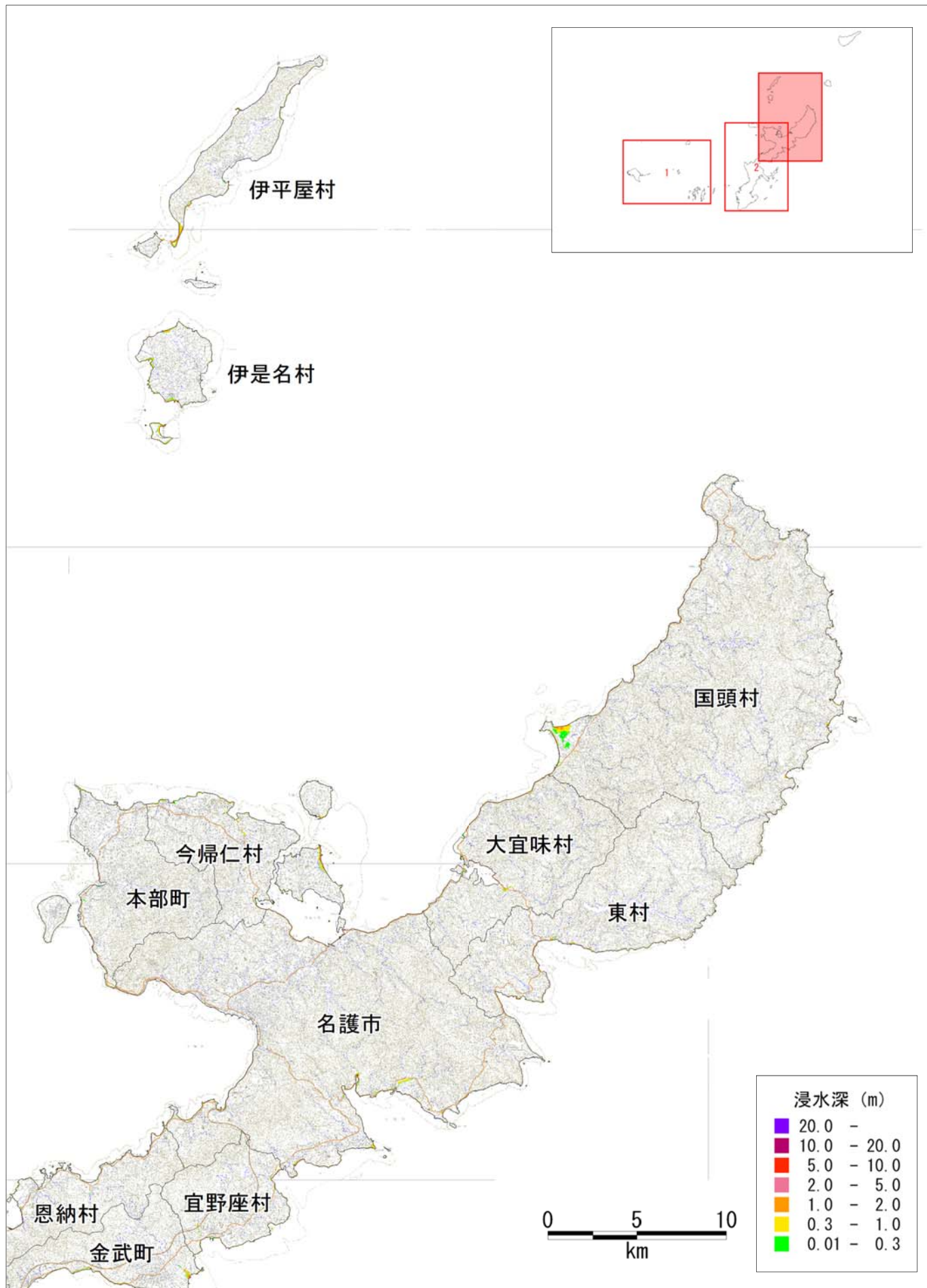
図 津波の浸水分布 【ケース①「駿河湾～紀伊半島沖」に「大すべり域+超大すべり域」を設定、 堤防条件：津波が堤防等を越流すると破堤する】
