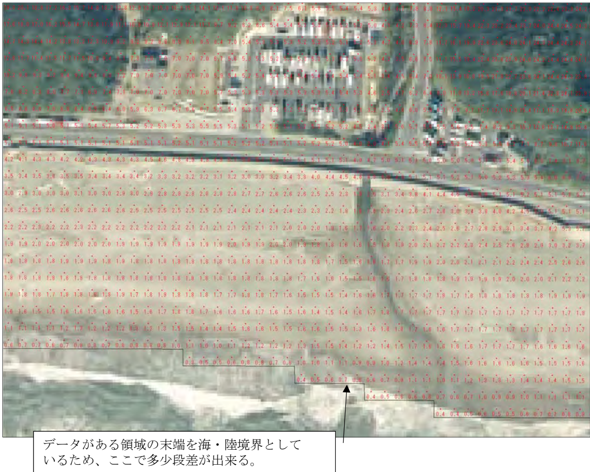
図3.5 海陸境界付近での国土地理院河川LPデータと砂防LPデータの 標高値(m)
