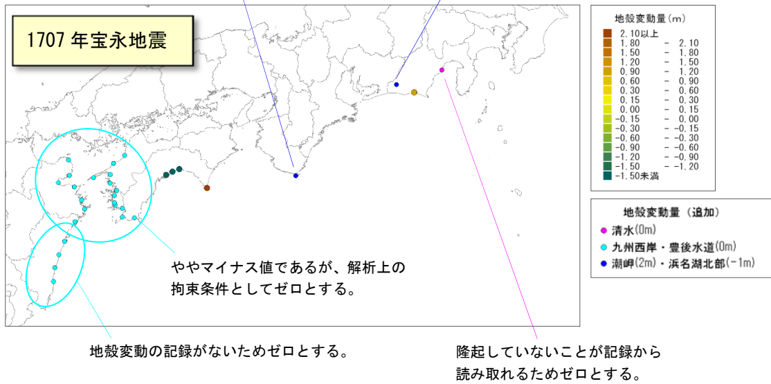
図3-6(1). 地殻変動量データ (1707年宝永地震のインバージョン解析に使用)
