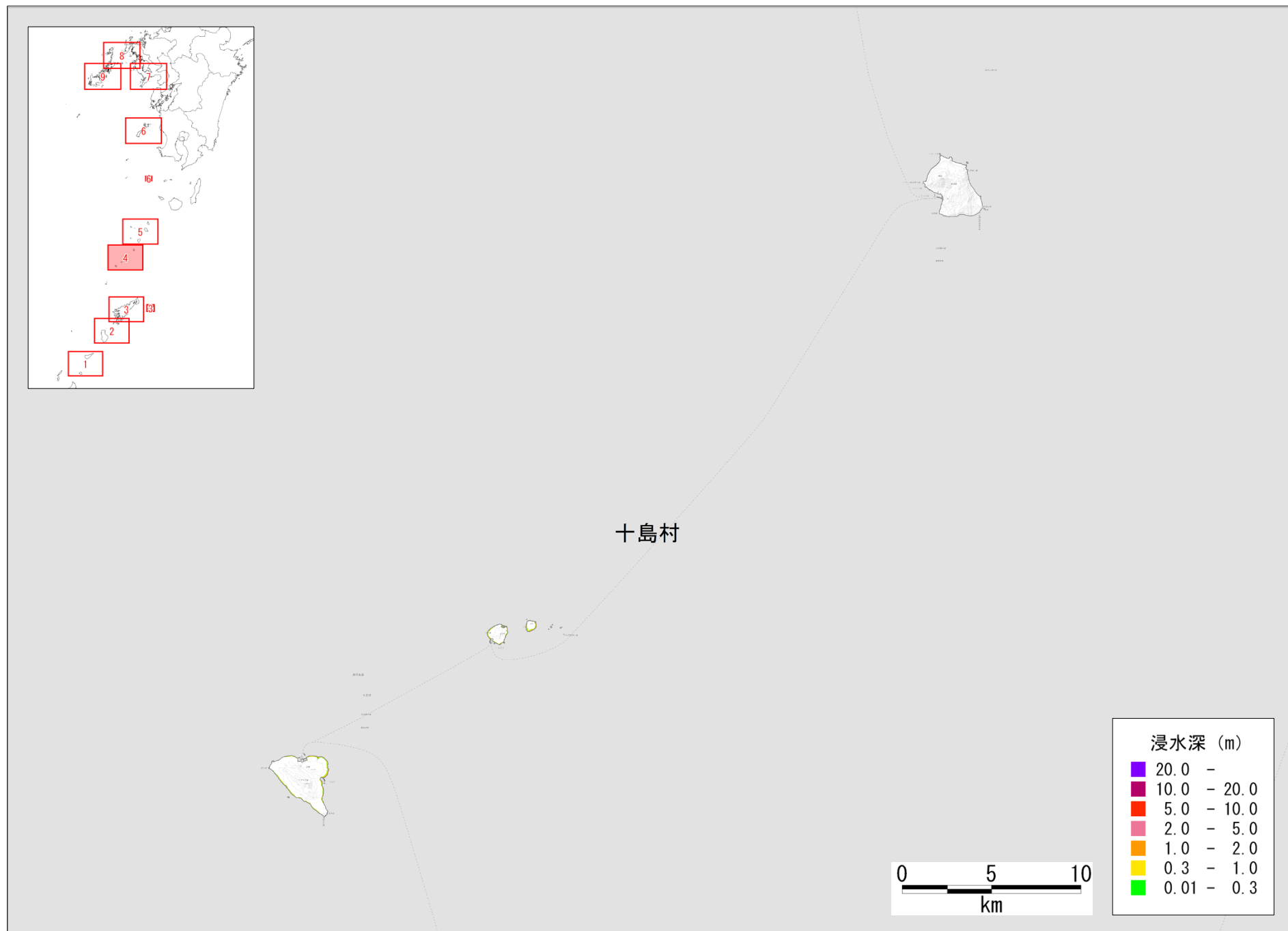
図 津波の浸水分布 【東側半割れモデル、堤防条件:津波が乗り越えたら破堤する】
