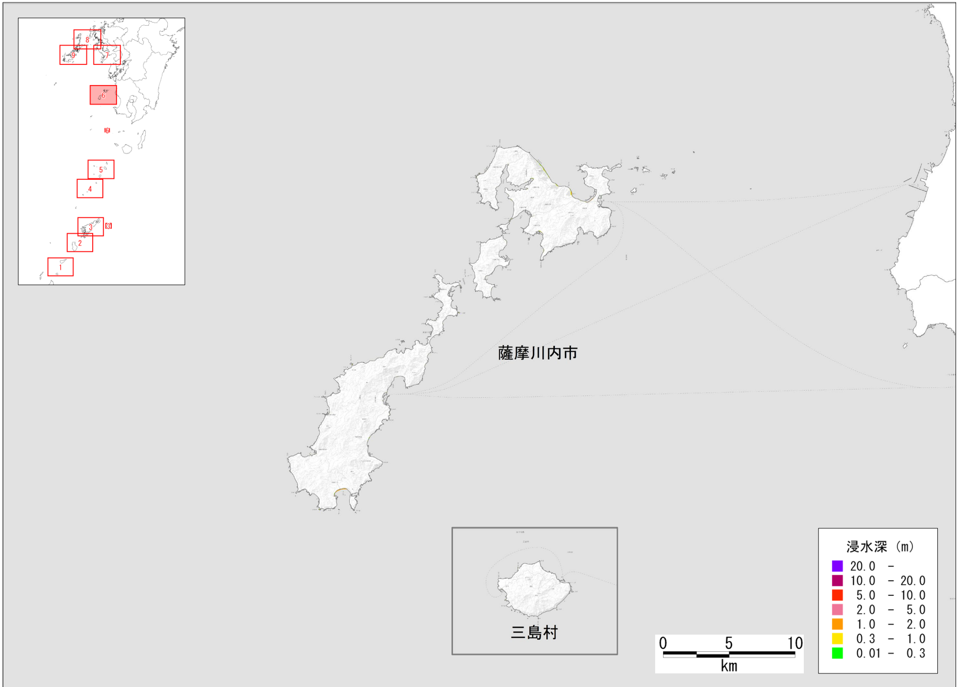
図 津波の浸水分布 【東側半割れモデル、堤防条件：津波が乗り越えたら破堤する】
