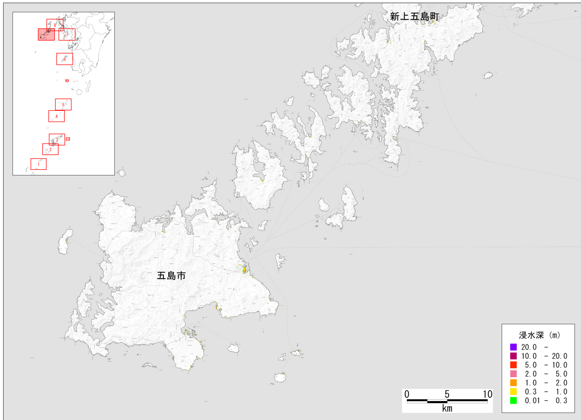
図 津波の浸水分布 【西側半割れモデル、堤防条件：津波が乗り越えたら破堤する】
