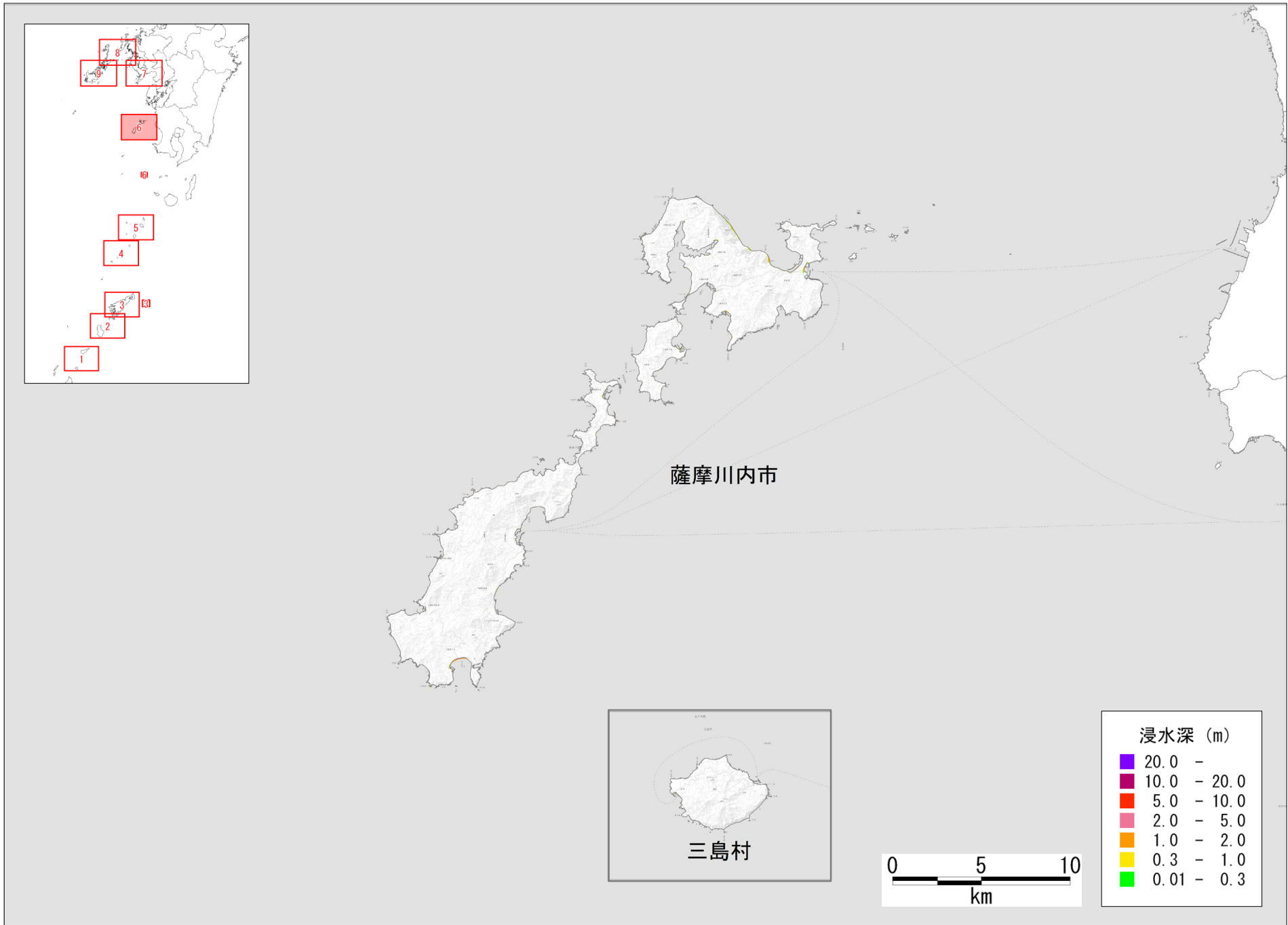
図 津波の浸水分布 【西側半割れモデル、堤防条件:津波が乗り越えたら破堤する】
