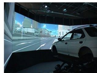
研究用ドライビングシミュレータ (国総研・慶應義塾大学共同開発)
