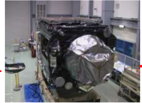
衛星組立後電気性能試験 (2009.11.21-11.22)
