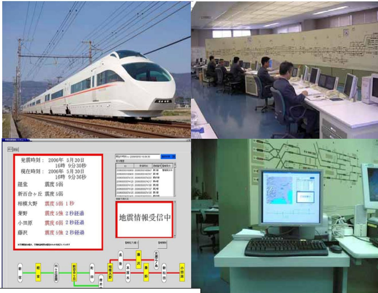
小田急電鉄では、沿線で震度5弱程度以上の揺れが推定された場合には中央司令室からすべての列車に停止するよう指示を出す。
