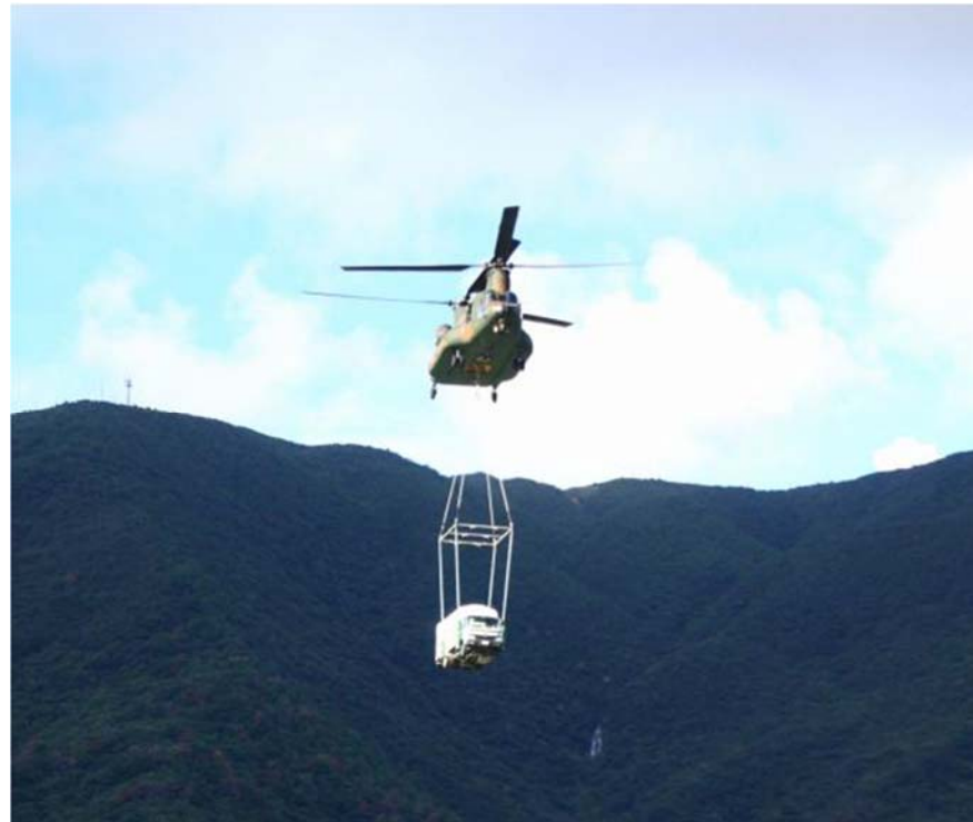
図 ヘリコプターで搬送される発電機車
