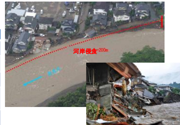
河岸侵食に伴う家屋倒壊
