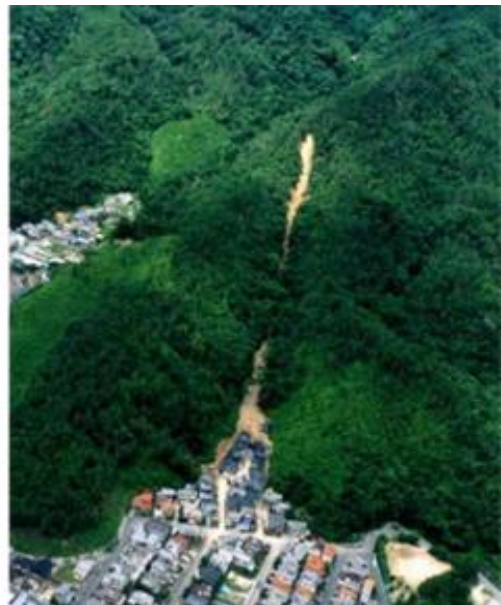
図-3.1(1) 土砂災害警戒区域等（土石流）のイメージ図
