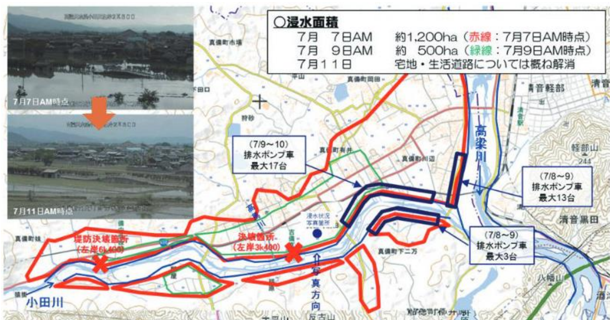
浸水状況と排水ポンプ車稼働状況
