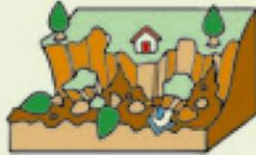
地中に染み込んだ水分により、急な斜面が突然崩れ落ちること。
