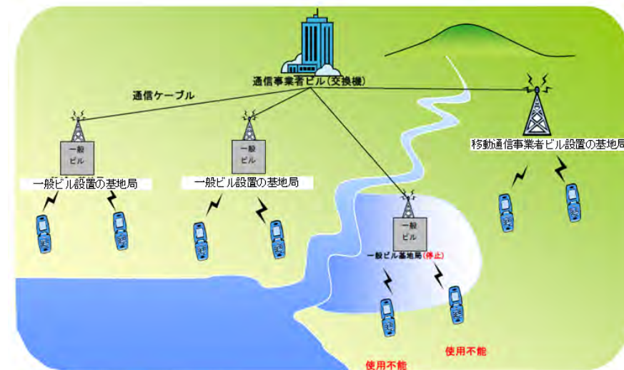
浸水による携帯電話への影響概念図(一部加筆) (出典:国土交通省「水害の被害指標分析の手引」(H25 試行版))
