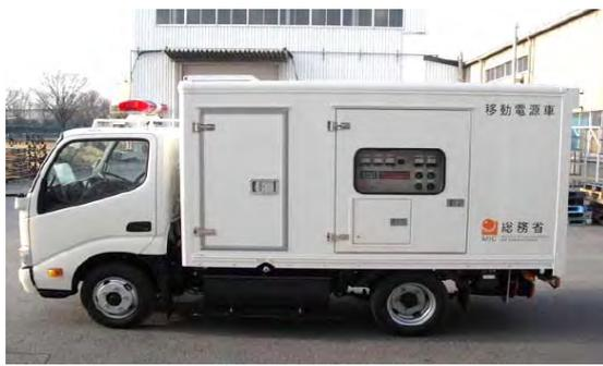
写真 3-9. 災害対策用移動電源車
