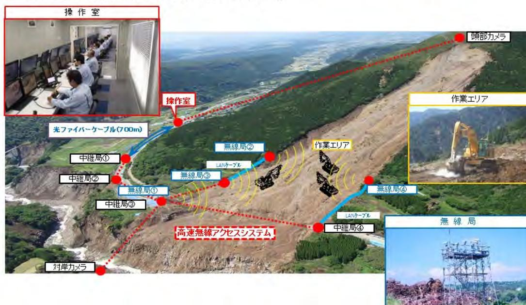
図 1-5. 無人化施工による砂防工事
