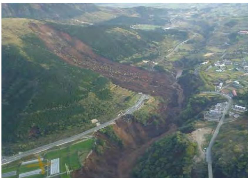
写真 1-20. 阿蘇大橋地区の自然斜面崩落箇所
