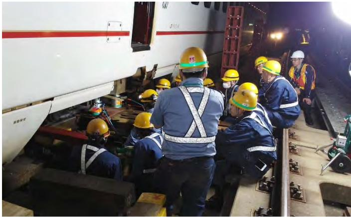
写真 1-28. 昼夜体制で脱線車両（九州新幹線）の撤去作業を実施
