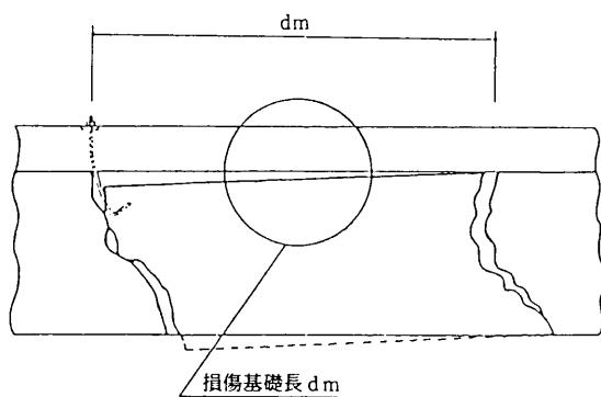
図版出典：「震災建築物等の被災度判定基準および復旧技術指針（木造編）」（財）日本建築防災協会
