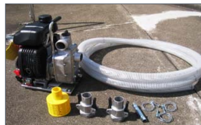
エンジンポンプ (プールから生活用水を汲み上げるため)
