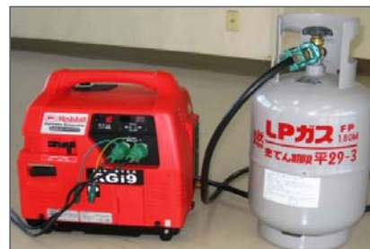
非常用発電機 (燃料のガスも備蓄)
