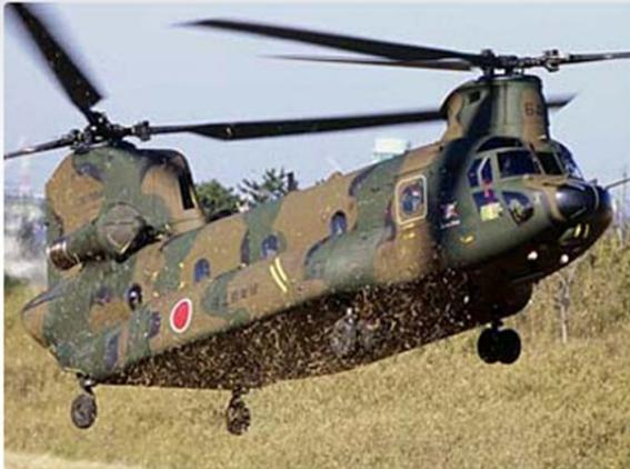
CH-47Jの性能向上型。大型燃料タンク化され長距離輸送能力の向上を図った。平成7年度から取得。
