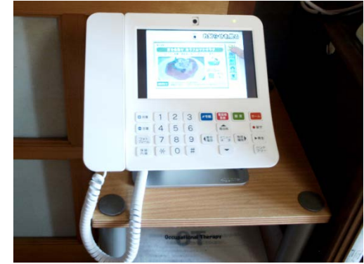
IP告知システム ピーちゃんねっと端末(出典:岩泉町ホームページ) 地域IPネットワーク網を活用して、役場と住民の双方間で、J-ALERT・地震・台風・豪雨・津波などの災害時緊急放送や行政放送を行うもの
