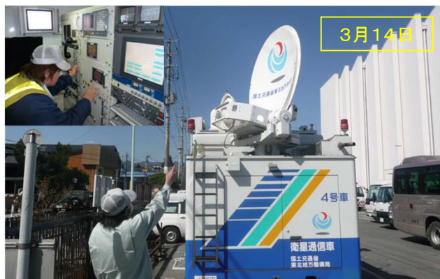
相馬市に衛星通信車を設営 (東北整備局TEC-FORCE)
