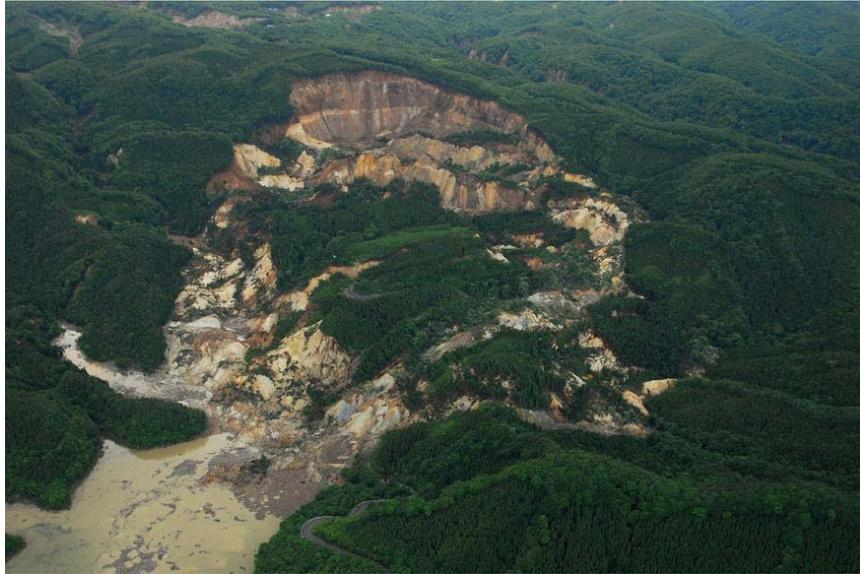
写真 4-4 岩手・宮城内陸地震 荒砥沢ダム上流部の大規模地すべり
