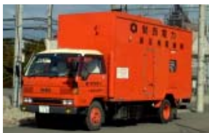
発電機車(50/60Hz切替式)
