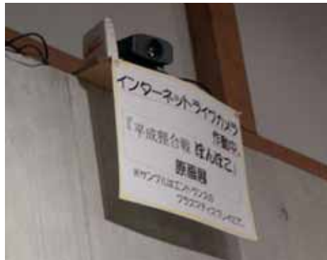
センター展示室壁面に設置されたカメラ。 実験により、全体が分かり、かつプライバシーが守られるカメラ位置がここ
