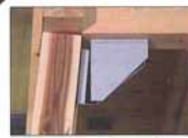
性能確認の実験時に変形する仕口ダンパー
