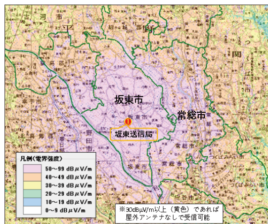
図1 坂東局電波伝搬シミュレーション
